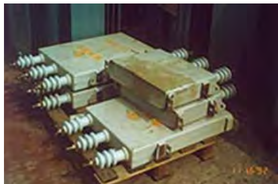
Condensadores con más de 500 000 ppm de PCB
