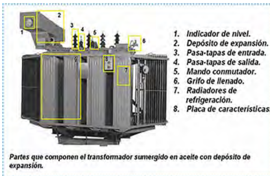
Figura 1. Partes del transformador 82
