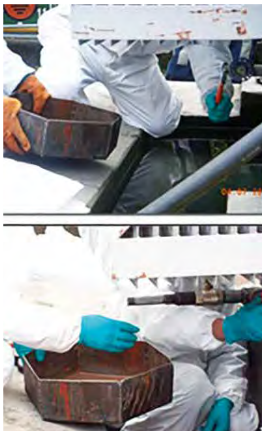
Figura 1. Toma de muestras utilizando batea y EPP recomendados.
